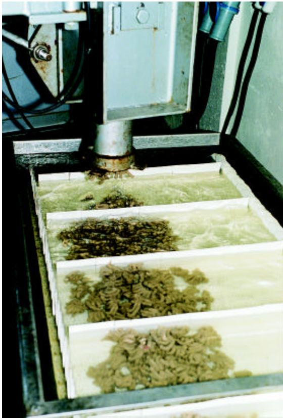
Figur7.9: Våt pellets fra pelleteringsmaskin geles til faste pellets i syrebad.
