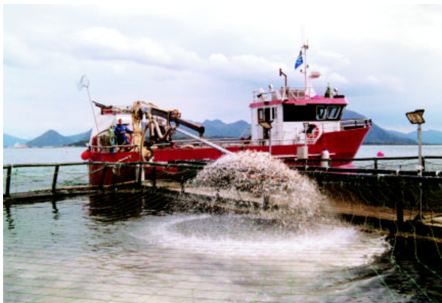
Figur 7.10: Utfôring av RUBIN-fôr med vakuumpumpe hos Øyfisk AS i Vesterålen.
